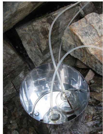
写真 1. SF 6 用の試料の採水状況
