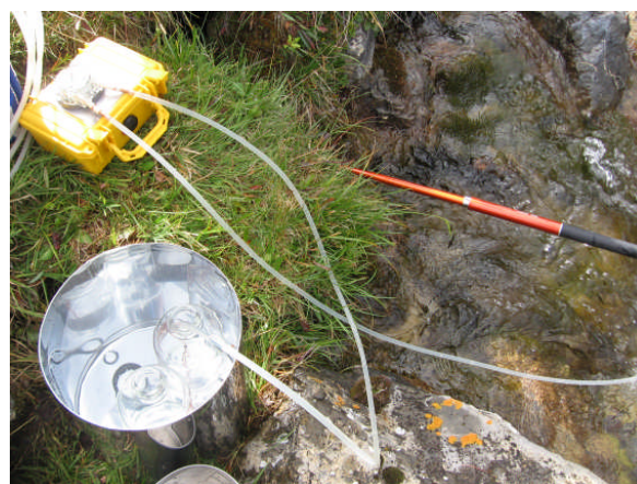
写真 4. チューブポンプによる湧水採取
